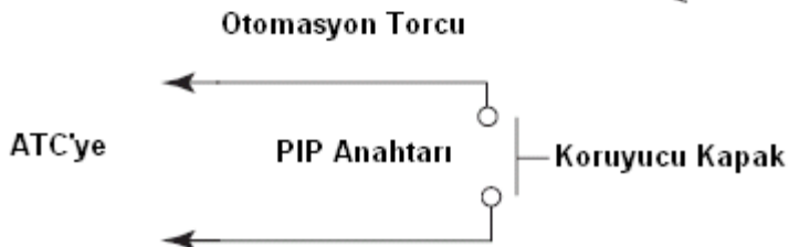
Makine Torcunun Tümleşik Parçalar Devre Şeması
