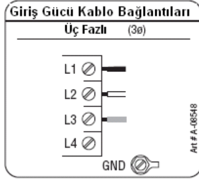
Üç Fazlı Giriş Gücü Bağlantısı
